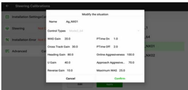
**Guadagno WAS:** L'impostazione predefinita è 20, valida solo in modalità senza angolo. Quanto minore è la sensibilità dello sterzo, tanto più sensibile è la rotazione della ruota anteriore. Quando lo spazio di sterzata del veicolo è grande o il terreno di lavoro è morbido e in pendenza, è necessario ridurre il valore e impostarlo su 10.
