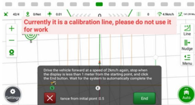
Fase 5: fare clic su Completa per terminare la calibrazione. Se l'indicazione è fallita, riprovare. Prestare attenzione al livellamento del terreno e al mantenimento della velocità.
