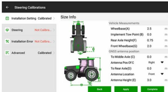
Interasse delle ruote anteriori e posteriori (A): Misurare la distanza tra l'asse di rotazione della ruota anteriore e l'asse di rotazione della ruota posteriore. Si noti che il metro a nastro deve essere parallelo al terreno.
