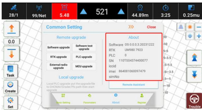
La sezione Informazioni sul sistema visualizza i seguenti dettagli: Numero di versione del software, modello della scheda RTK, numero di versione del PLC, SN del tablet, informazioni sulla SIM.
